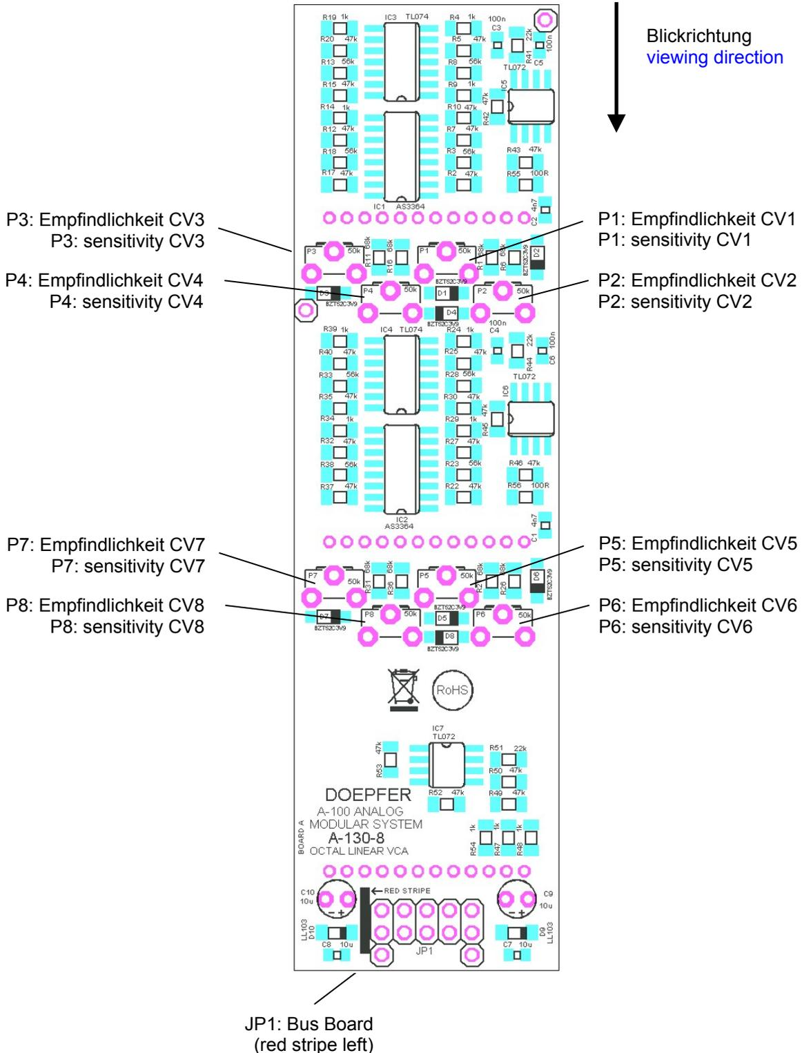
Drehung des betreffenden Trimpotentiometers gegen den Uhrzeigersinn erhöht die Empfindlichkeit der Steuereingang
