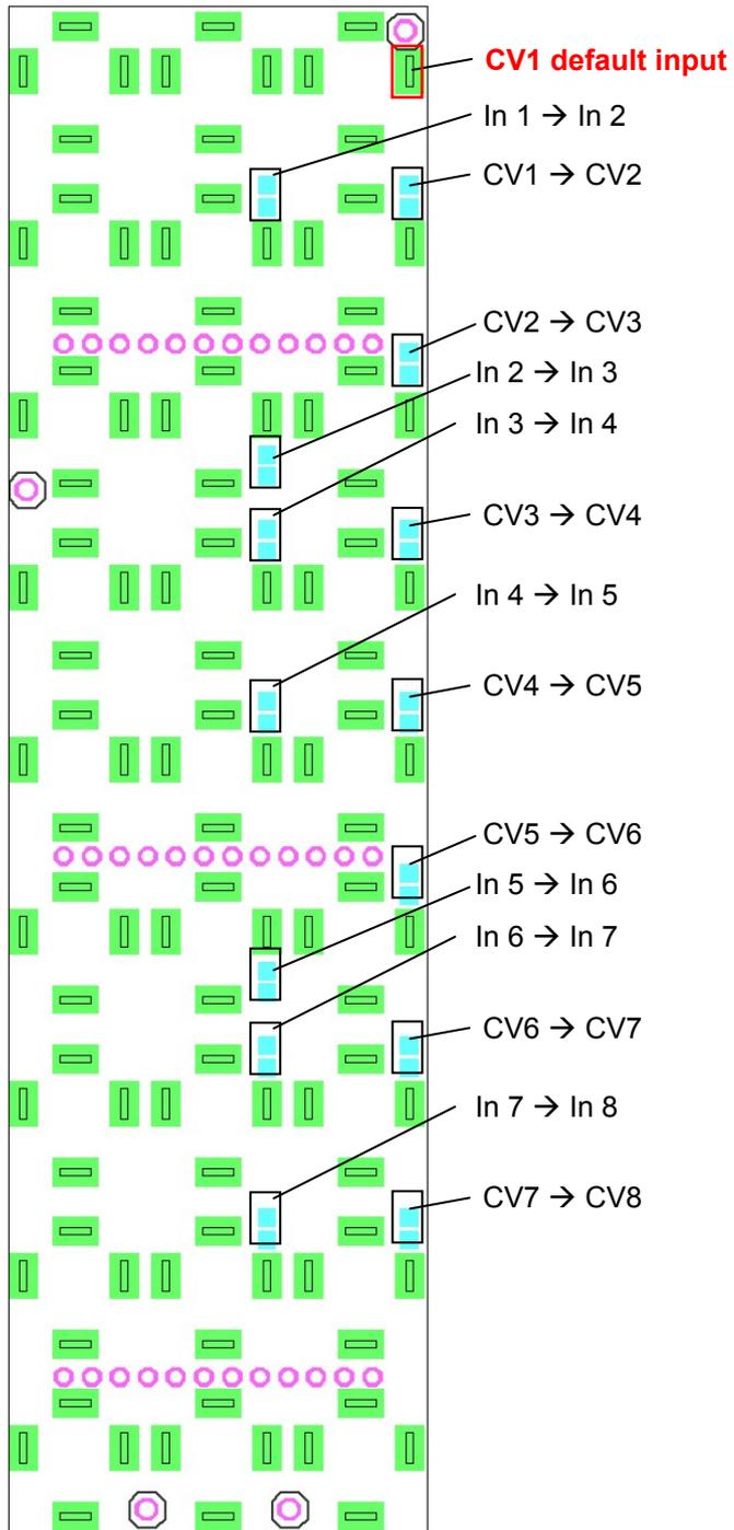
die Verbindungen (Blankdrähte) abgezwickelt werden, die die beiden Leiterplatten mechanisch zusätzlich zusammenhalten. Bitte führen Sie alle Arbeiten sehr sorgfältig durch (insbesondere die korrekte Verbindung der Leiterplatten mit den Stift- und Buchsenleisten nach der Modifikation). Andernfalls geht der Garantieanspruch verloren.
